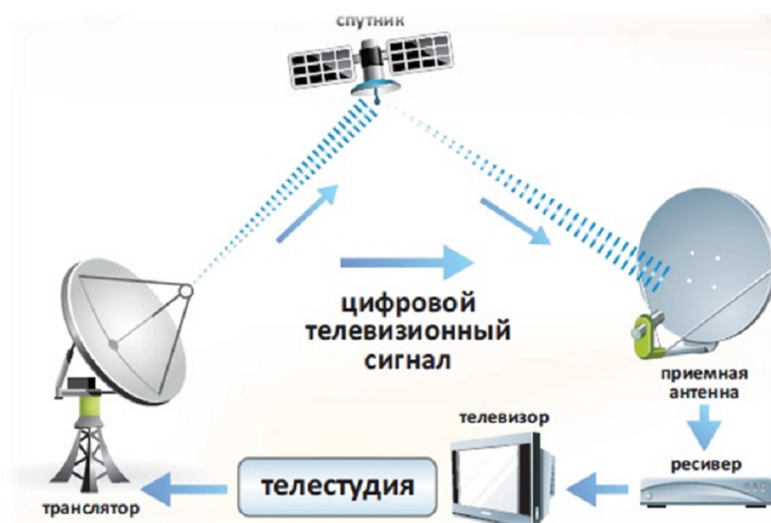
Рис. 1. Трансляция телевизионного цифрового сигнала со спутника (источник: https://museumgagarin.ru/news/iskusstvennyy_sputnik_zemli_televizionnogo_veshchaniya_ekran/?utm_medium=organic&utm_source=yandexsmartcamera )
