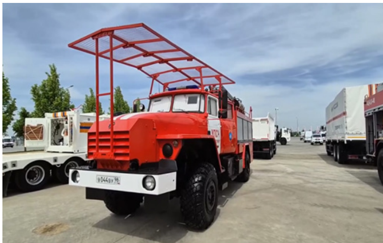
Рис. 2. Пожарный автомобиль, оборудованный антидроновой защитой и бронированием наиболее уязвимых участков конструкции
